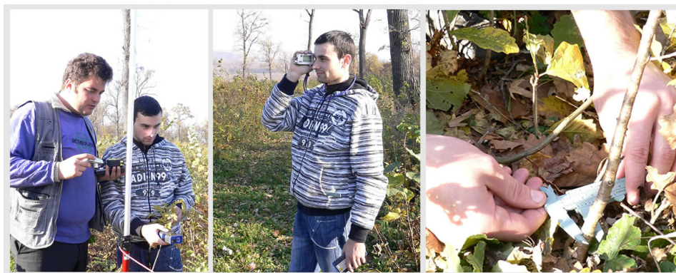
Figura 2.3. Instrumentele utilizate în prelevarea datelor (telemetrul laser tip Leica DISTO și hipsometrul ultrasonic tip Haglof Vertex IV)
