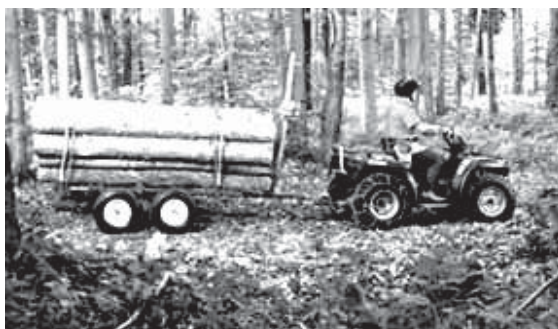
Figura 1. Mijloc de colectare prin purtare cu dimensiuni de gabarit reduse Figure 1. Small-scale forwarding equipment
